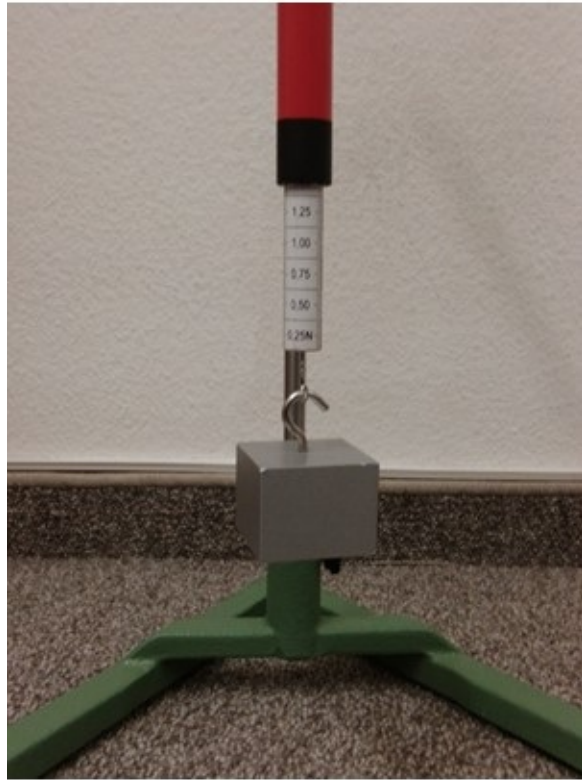
Aluminiumklotz an Federkraftmesser in Luft
