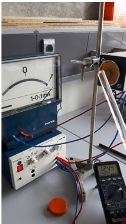
Aufladung vom geriebenen Stäben angezeigt mit dem Elektrofeldmeter
